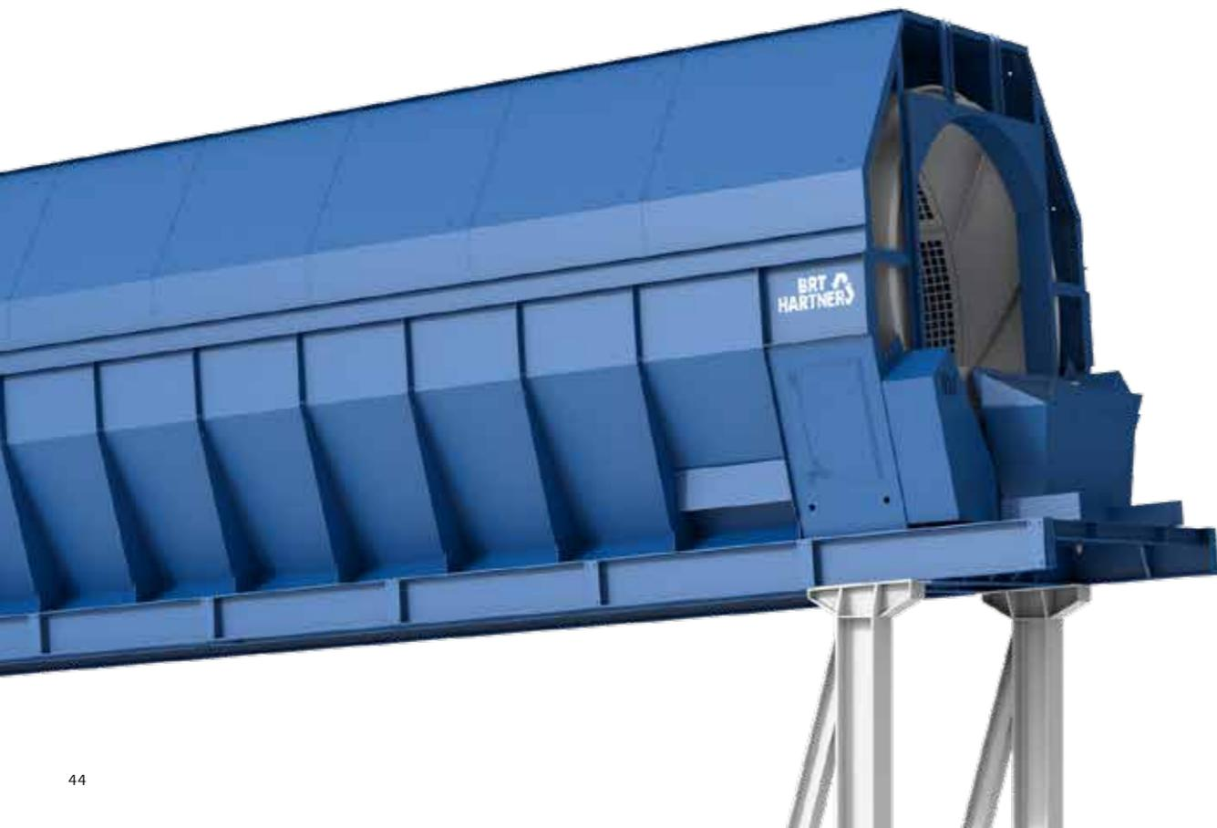
**SD** Siebtrommeln werden eingesetzt zum Absieben von Gewerbeabfall, Hausmüll und anderen Materialien. Absiebungen in mehreren Stufen mit unterschiedlich großen Öffnungen sind möglich. Die typischen Siebschnitte liegen zwischen 60 und 300 mm. Die SD Siebtrommeln wenden und werfen das Material so intensiv, dass optimale Trenngüten erreicht werden. Verschiedene Einrichtungen zum Schutz vor Wicklungen machen dieses 3D-Sieb sehr wartungs- und reinigungsfreundlich.
