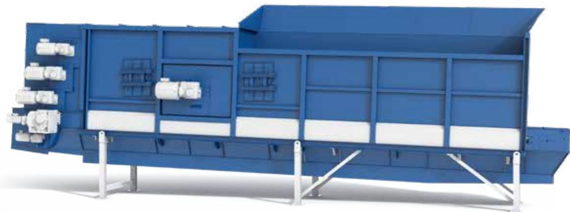
Der Gärrestmischer BRT HARTNER **DM** ist das Aggregat zur Herstellung von optimalen Mischungen aus Gärrest, Klärschlamm o.ä. auf der einen sowie strukturbildenden Materialien wie beispielsweise Grünabfall, Rohkompost oder Siebüberlauf auf der anderen Seite. Auf Grund der Systematik des Mischens der Substrate durch Mischwalzen im dynamischen Materialfluss werden Verdichtungs- oder Kneteffekte wirksam vermieden und das Substrat homogenisiert und aufgelockert.
