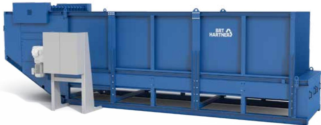
Der BRT HARTNER **BB** Ballen-Auflöser löst Pressballen aus PET-Flaschen, Altpapier, Restmüll, Kunststoffen und einer Vielzahl von anderen Wertstoffen auf. Das Material wird dosiert an nachfolgende Bearbeitungsprozesse weitergegeben. Der Ballen-Auflöser zerkleinert das Material nicht, sondern vereinzelt es, sodass eine effektive Nachverarbeitung erfolgen kann.
