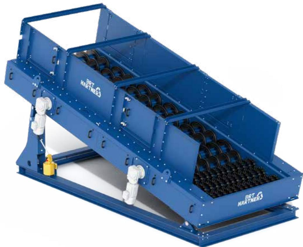
**SC** Rotorsiebe bieten eine zuverlässige, störstoffunempfindliche und langlebige Lösung zur Sortierung von Altpapier und Pappen. Das Eingangsmaterial wird vorn aufgegeben. Die Pappen und Kartonagen „schwimmen“ über das Sieb. Das Mischpapier wird durch die Rotorsiebscheiben nach unten gezogen.
